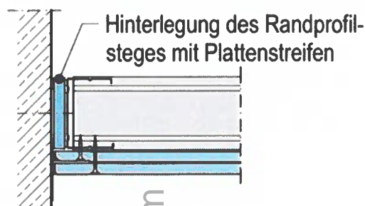
Abbildung 1: Wandanschluss bei Wandhöhen > 3 m
